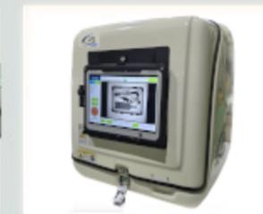
X線非破壊検査装置
